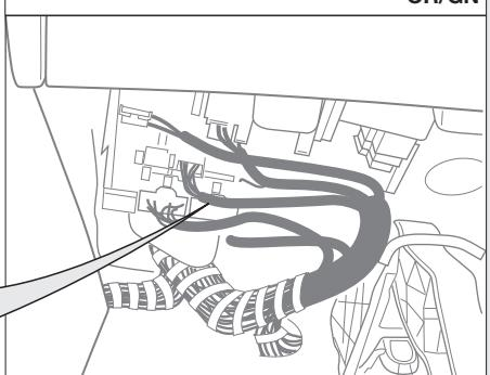
Bordnetzsteuergerät Position "G"
