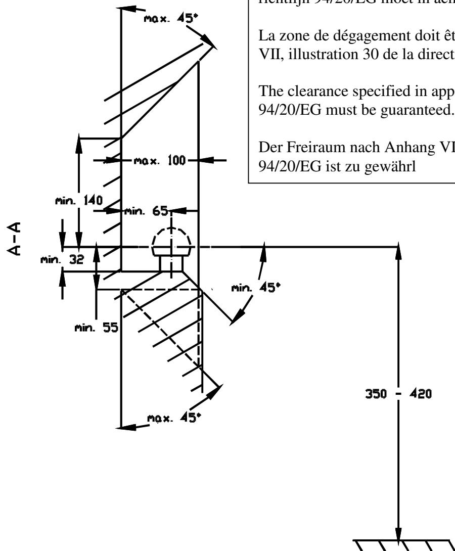
La zone de dégagement doit être garantie conformément à l'annexe VII, illustration 30 de la directive 94/20/CE.
