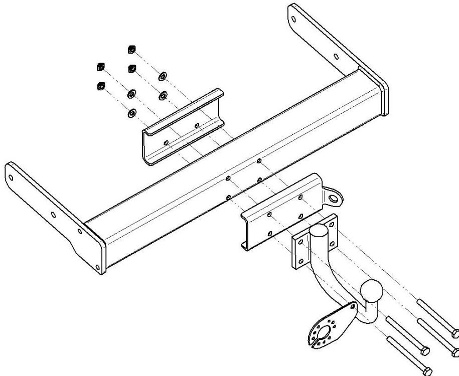
**Schrauben:** M10x130, U-Scheibe und Mutter. (Es werden Schrauben der Klasse 8.8 verwendet. (*In der Anbauanleitung des Kugelkopfes stehen Schrauben der Klasse 10.9; diese werden nicht benötigt!*) Das Steckdosenblech kann variabel an verschiedenen Positionen (Bohrungen) verschraubt werden. Anstatt der abgebildeten Kugelkopfes kann auch ein anderer Typ angeschraubt werden.
