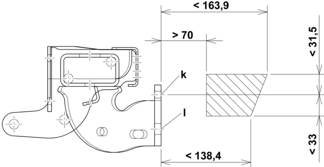
Kuppelbereich für Kupplungskugeln mit Halterung oder selbsttätige Bolzenkupplungen.
