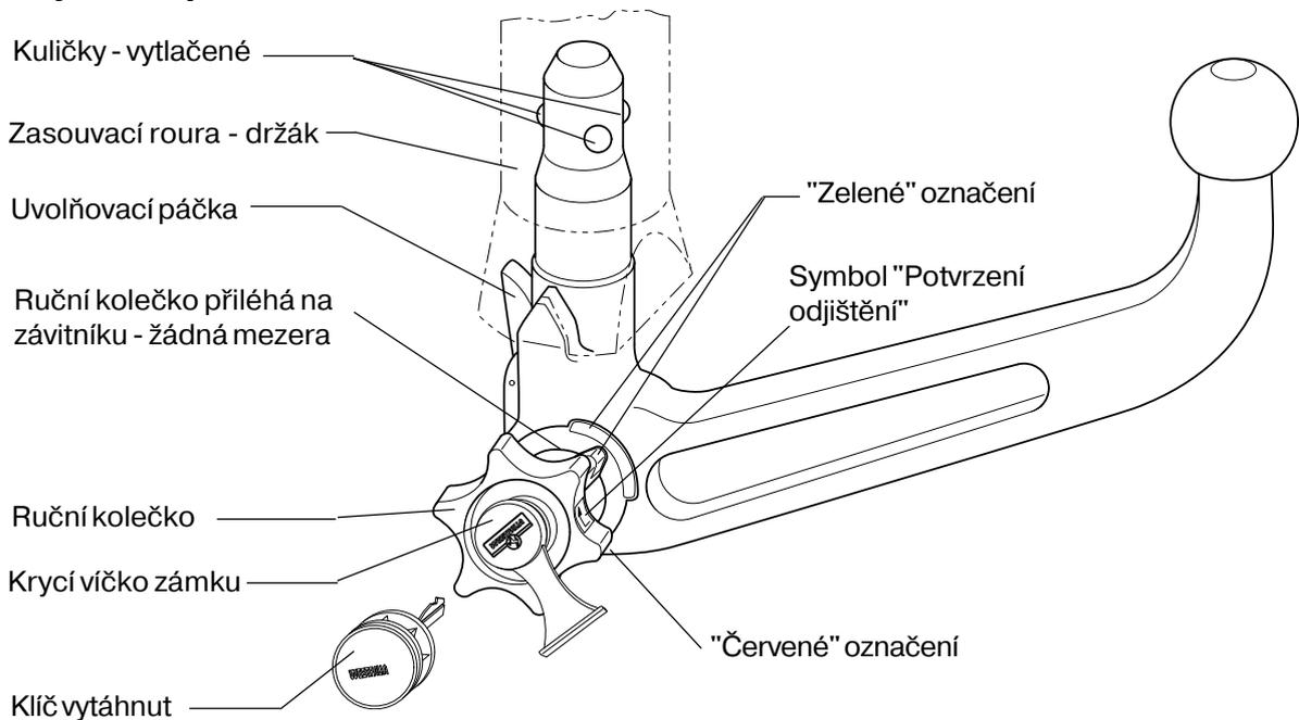
**Odjištěná pozice Vyndání kulové tyče**
