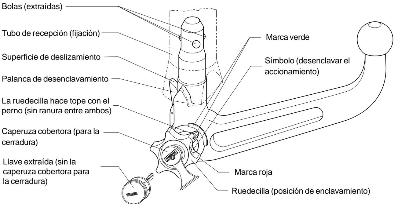
**Posición desenclavada (desmontado)**
