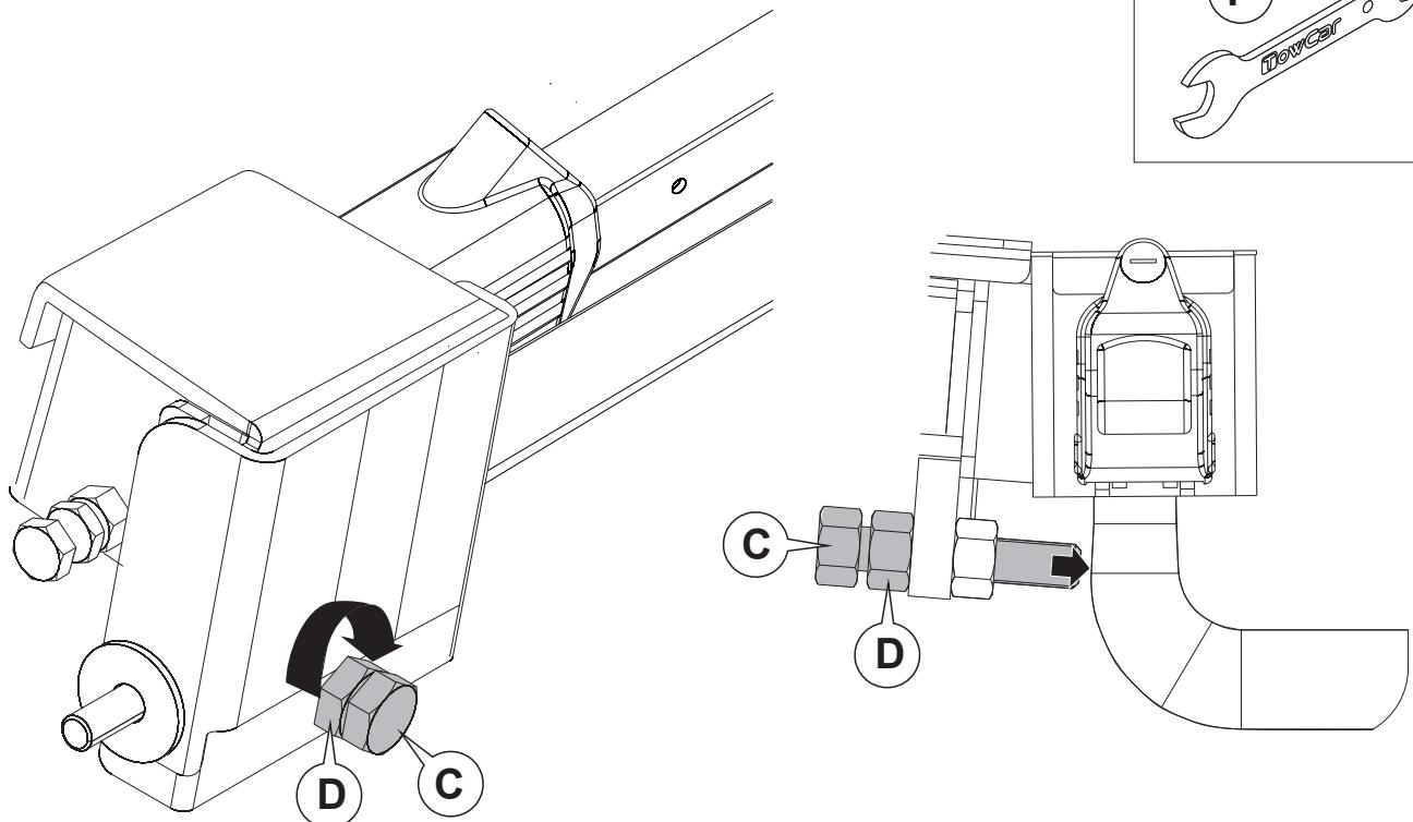
**ES** Ajuste del sistema antibalanceo: Afloje la contratuerca (D) y gire el tornillo (C) hasta que haga contacto con el cuello de la bola del enganche. Vuelva a apretar la contratuerca (D). Esta operación se realizará solo la primera vez que coloquemos nuestro portamotos en el vehículo o si lo colocamos sobre un vehículo diferente al nuestro.
