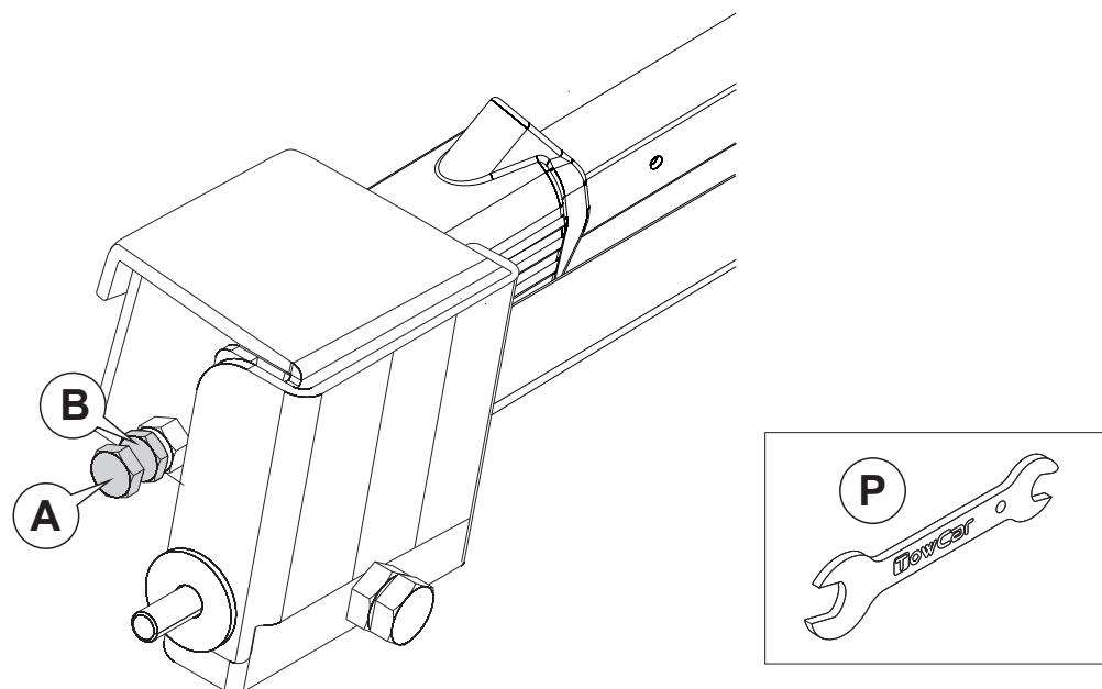
**ES** Ajuste del cabezal: Afloje la contratuerca (B), apriete el tornillo (A) hasta que el cabezal no pueda girar (en caso de que no sea posible bajar la palanca con la fuerza de la mano, afloje un poco el tornillo). Una vez se consiga un buen ajuste, apriete la contratuerca (B). Esta operación debe ser repetida cada cierto tiempo.
