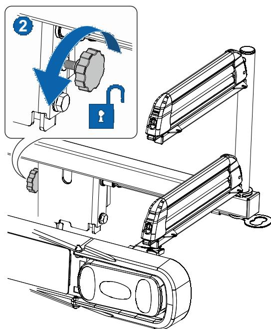
**ES** Para poder circular, empuje el conjunto hasta su posición vertical y verifique el doble sistema de bloqueo (A+B).
