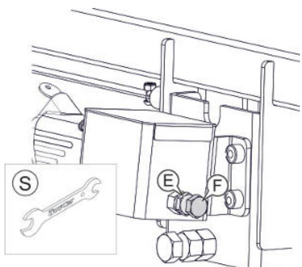
**IT** Regolazione della testa: allentare il controdado (E), serrare la vite (F) fino a immobilizzare completamente la testa (in caso non sia possibile, abbassare la leva manualmente e allentare leggermente la vite). Una volta ottenuta la regolazione desiderata, serrare il dado di bloccaggio (E). Questa operazione deve essere ripetuta periodicamente.
